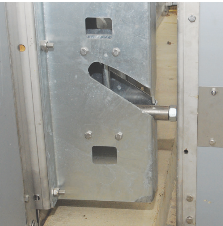
Der eingebaute Mechanismus hebt das Tor aus dem Stroh.
