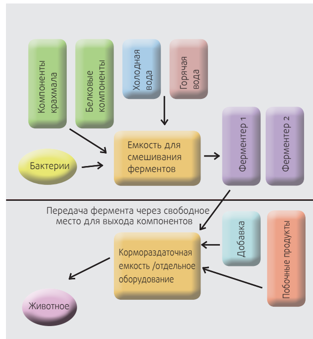
Смешивание на отдельном оборудовании (напр.: FermCube)
