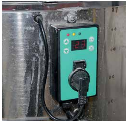
Der Behälter besitzt eine integrierte Heizung, die den Inhalt auf maximal 40 °C aufheizt.
