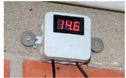
Dank der selbst gebauten Temperaturanzeige weiß der Landwirt im Vorübergehen, ob die zum Anmischen erforderlichen 38 °C erreicht sind.
