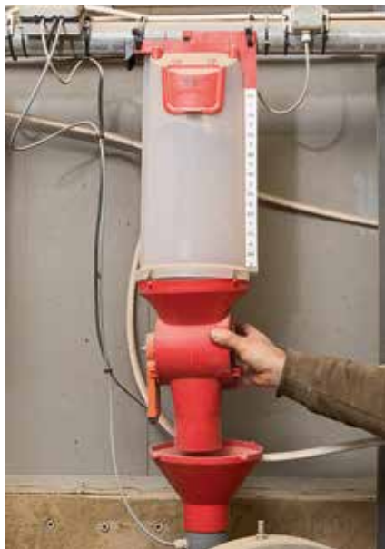
Das Futter fällt aus der demontierbaren Zellenradschleuse über einen Trichter in das Fallrohr.
