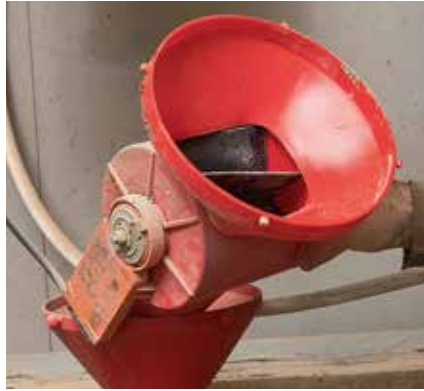
Die Zellenradschleuse dosiert immer nur eine kleine, exakt definierte Menge Futter aus.
